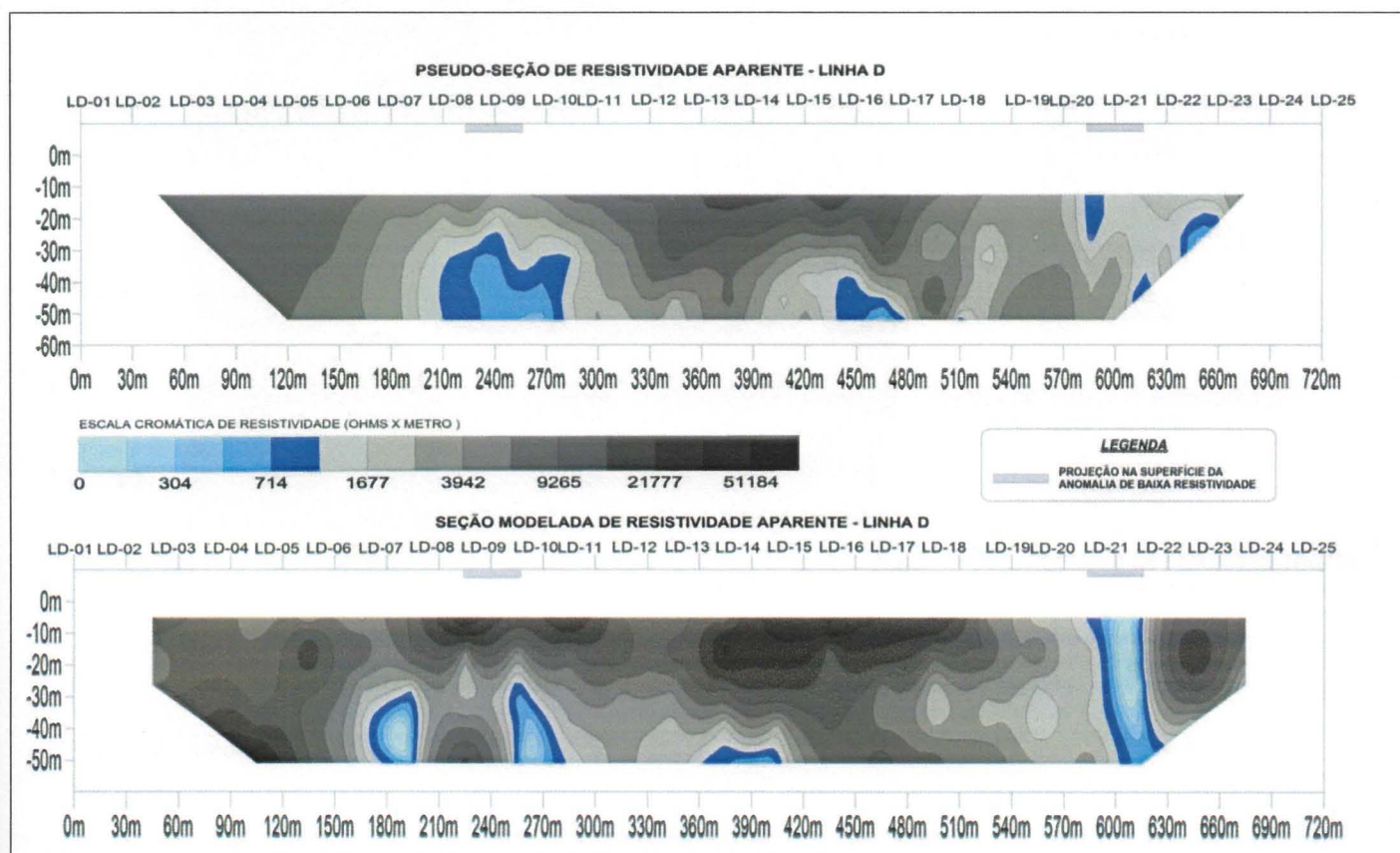
Figura 20. Pseudo-seção de resistividade aparente e seção modelada de resistividade da Linha D.
